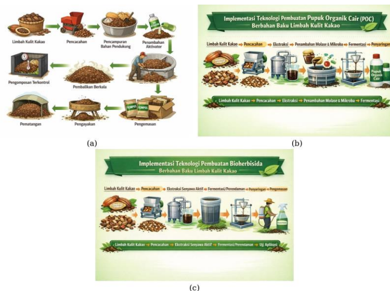
Gambar 3. Skema teknologi pengolahan limbah kulit kakao: (a) kompos; (b) pupuk organik cair; (c) bioherbisida
